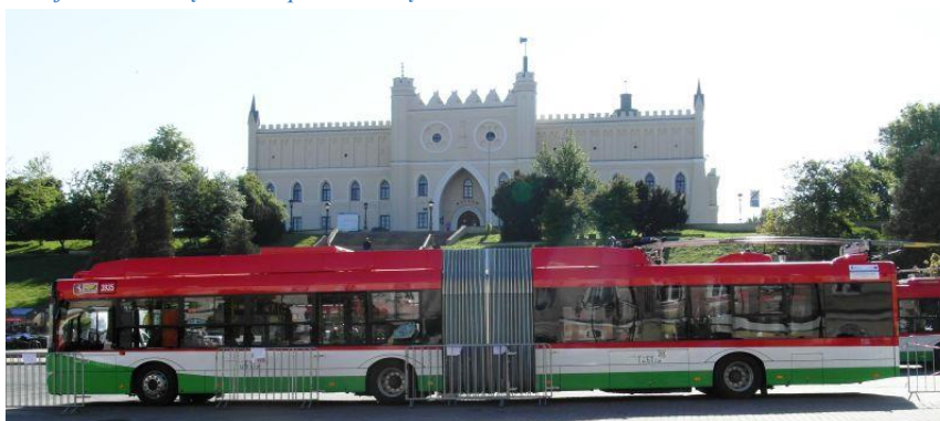
Fot. 3 Ursus T 70116 – trolejbus z baterią litowo-polimerową
