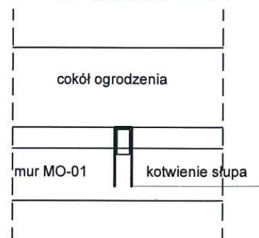
Schemat mocowania tulei słupów piłkochwyty - widok z góry 1:25
