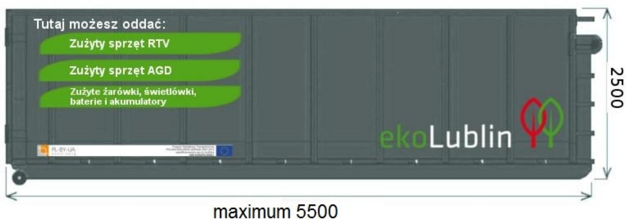
Rys. 2 - Kontener do selektywnej zbiórki zużytego sprzętu elektrycznego i elektronicznego pojemność minimum 28 m 3 – rysunek poglądowy.
