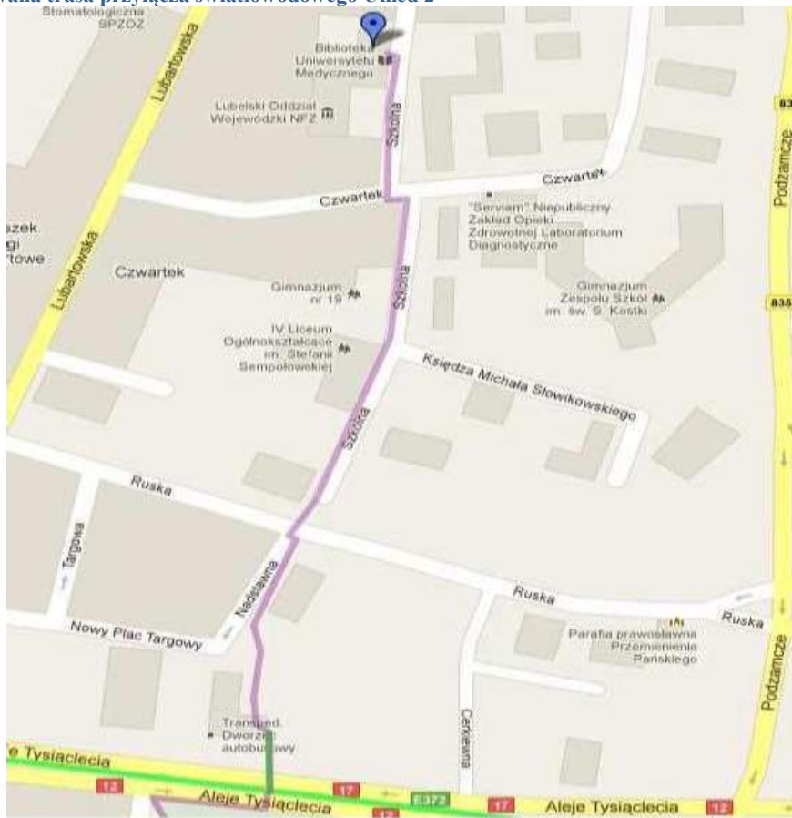
Ryc. 17. Schemat rozplywu włókien dla podłączenia Teatr NN, Umed2, Umed3
