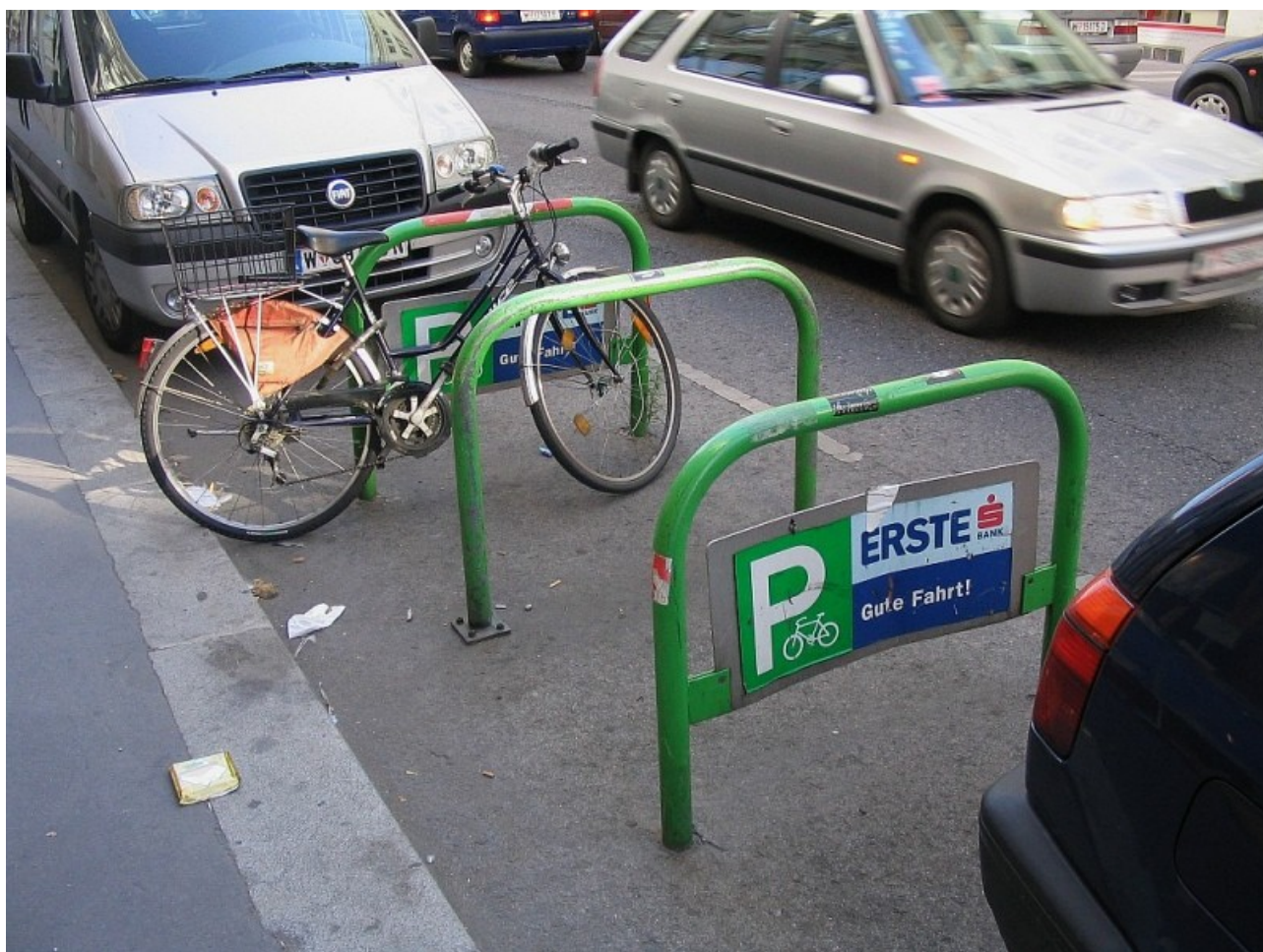
Rys. 7. Wiedeń, stojaki rowerowe umieszczone w jezdni zamiast miejsca parkigowego dla samochodów. Taka lokalizacja jest pożądana gdyż nie zajmuje miejsca na chodniku a zarazem pozwala na łatwy dostęp do stojaka zarówno z chodnika jak i jezdni, na której odbywa się ruch rowerowy. Fot. Marcin Hyła.
