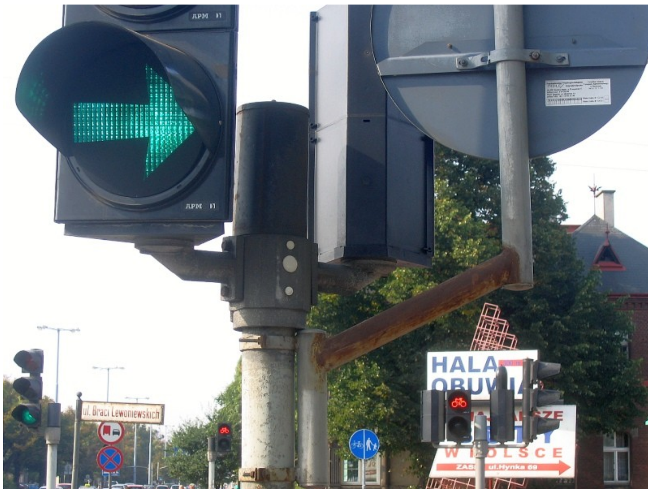
Rys. 10. Nielokalizyjna sygnalizacja świetlna: sygnał kierunkowy S-3 dla prawoskrętu ruchu ogólnego wyświetla się jednocześnie z sygnałem czerwonym w S-6 dla rowerzystów na wprost. Fot. Marcin Hyła.
