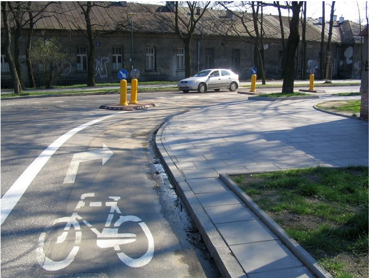
Rys. 17. Kraków, kontrapas w ul. Kopernika. W miejscach o pogorszonej widoczności wzajemnej rowerzystów na kontrapasie i kierujących poruszających się w jezdni zgodnie z ogólną organizacją ruchu - na przykład na łukach poziomych - zastosowano punktową segregację fizyczną: wyspy dzielące ze słupkami przeszkodowymi U-5b. Fot. Marcin Hyła.
