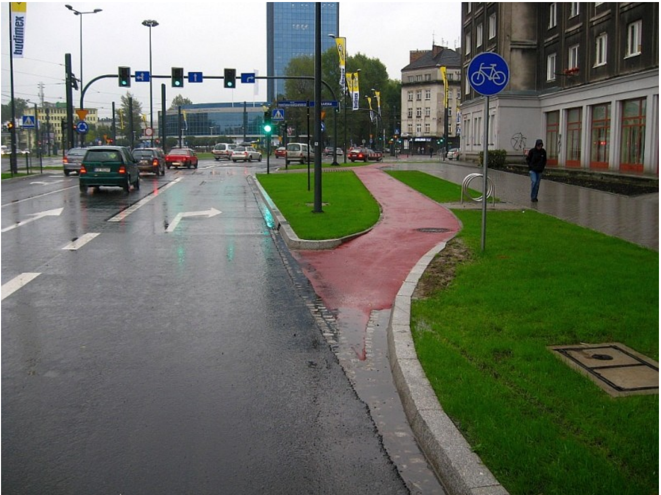
Rys. 20. Kraków, rondo Grzegórzeckie niedaleko Ronda Mogińskiego. Rozwiązanie analogiczne do przedstawionego na rys. 19 powyżej (zjazd na drogę rowerową poza jezdnią projektowany dla prędkości rowery powyżej 30 km/godz). ale z lepszym profilem i rozwiązaniem krawężników. Fot. Marcin Hyła.
