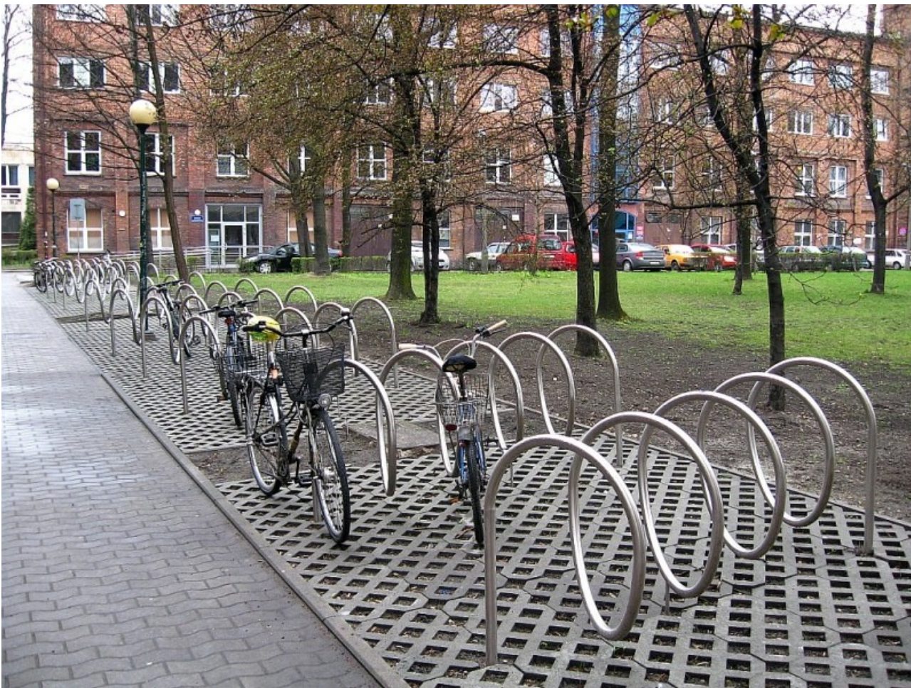
Rys. 8. Politechnika Krakowska. Stojaki rowerowe w formie spirali to rozwiązanie o ogromnej pojemności (każda spirala pozwala na parkowanie 8-10 rowerów z obu stron). Dlatego należy zadbać o właściwy dostęp do miejsc postojowych: odpowiednie odstępy między stojakami i odległość od przeszkód. Fot. Marcin Hyła
