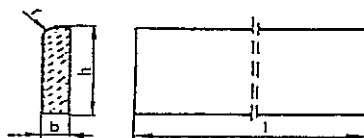
Rysunek 1. Kształt betonowego obrzeża chodnikowego
