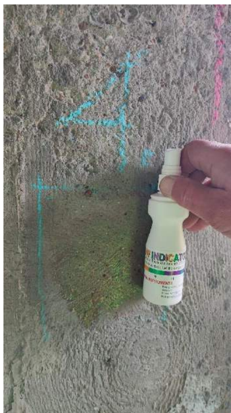
Fot. 4. Miejsce pomiarowe nr 4. Efekty kolorystyczne oddziaływania Rainbow - pH 11 –13, kolor fioletowy/niebieski - ochrona zbrojenia; pH 11, kolor zielony - wartość graniczna.
