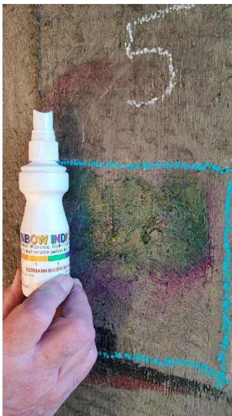
Fot. 1. Miejsce pomiarowe nr 5. Efekty kolorystyczne oddziaływania Rainbow - pH 11 –13, kolor fioletowy/niebieski - ochrona zbrojenia; pH 11, kolor zielony - wartość graniczna.
