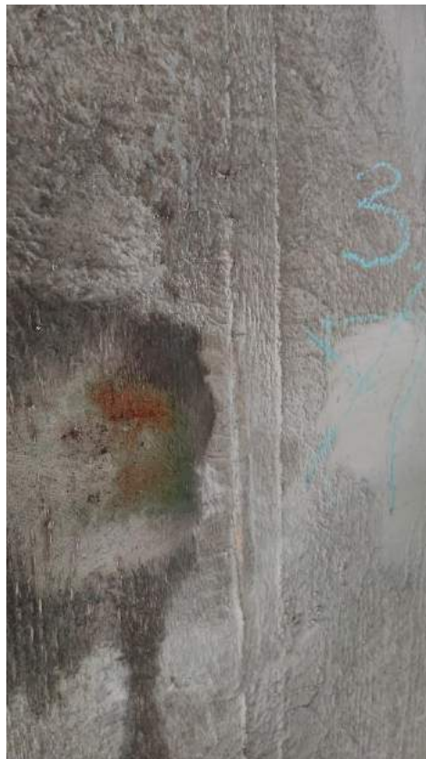
Fot. 3. Miejsce pomiarowe nr 3. Efekty kolorystyczne oddziaływania Rainbow - pH 11 –13, kolor fioletowy/niebieski - ochrona zbrojenia; pH 11, kolor zielony - wartość graniczna.
