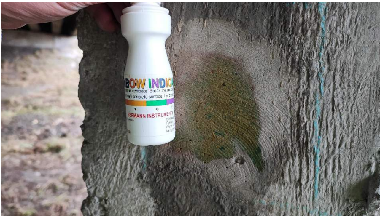
Fot. 1. Miejsce pomiarowe nr 1. Efekty kolorystyczne oddziaływania Rainbow - pH 11 –13, kolor fioletowy/niebieski - ochrona zbrojenia; pH 11, kolor zielony - wartość graniczna.
