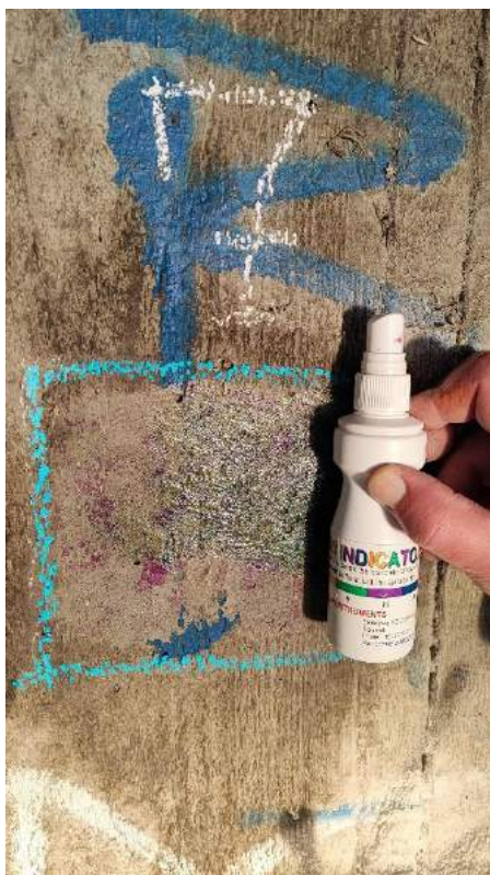
Fot. 4. Miejsce pomiarowe nr 7. Efekty kolorystyczne oddziaływania Rainbow - pH 11 –13, kolor fioletowy/niebieski - ochrona zbrojenia; pH 11, kolor zielony - wartość graniczna.
