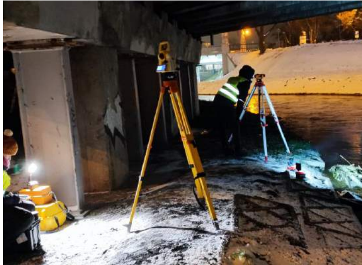
Rys. ?? . Pomiar ugięcia w przęśle środkowym - stanowisko pomiarowe
