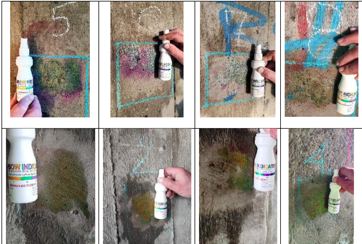
Rys. 4. Zestawienie pobranych rdzeni betonu poddanych działaniu preparatu RainBow
