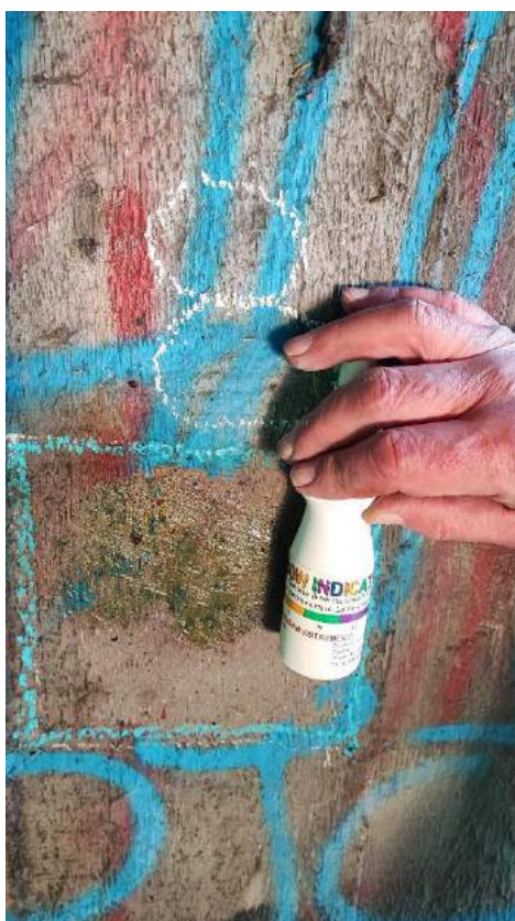
Fot. 5. Miejsce pomiarowe nr 8. Efekty kolorystyczne oddziaływania Rainbow - poniżej pH 9, kolor pomarańczowy/czerwony – zagrożenie korozyjne.
