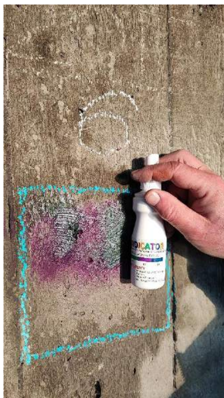
Fot. 3. Miejsce pomiarowe nr 6. Efekty kolorystyczne oddziaływania Rainbow - pH 11 –13, kolor fioletowy/niebieski - ochrona zbrojenia; pH 11, kolor zielony - wartość graniczna.
