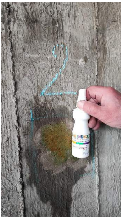
Fot. 2. Miejsce pomiarowe nr 2. Efekty kolorystyczne oddziaływania Rainbow - pH 11, kolor zielony - wartość graniczna, poniżej pH 9, kolor pomarańczowy/czerwony – zagrożenie korozyjne.
