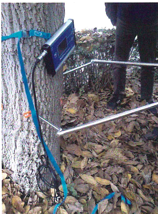
Ryc. 4. Suwmiarka elektroniczna Picus Calliper do pomiaru odległości pomiędzy sensorami [fot. M. Dudkiewicz]
