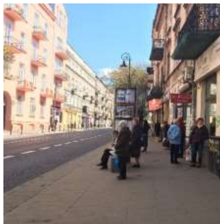
Fot. 27. Przystanek autobusowy z zatoką na ul. Narutowicza ogranicza szerokość chodnika wolnego od przeszkód. (zdj. TransEko).
