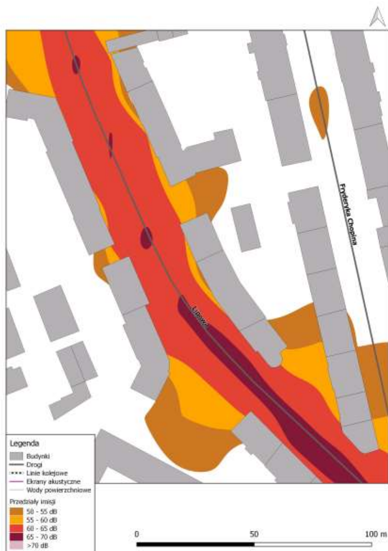
Rys. 8.43. Mapa imisji dźwięku – wskaźnik L_N , Al. Józefa Piłsudskiego i ul. Lipowa na odcinku od ul. Dolnej Panny Marii do ul. Marii Curie-Skłodowskiej, przed zastosowaniem działań naprawczych
