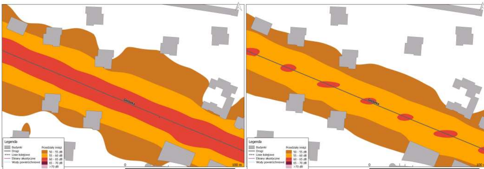
Rys. 8.35. Mapa imisji dźwięku – wskaźnik L_N , ul. Głęboka na odcinku od ul. Adama Szczerbowskiego do ul. Rektora Henryka Raabego, przed zastosowaniem działań naprawczych
