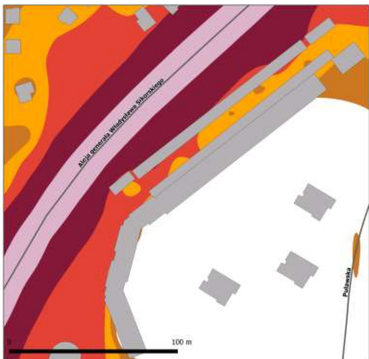
Rys. 8.23. Mapa imisji dźwięku – wskaźnik L_N , Al. Gen. Władysława Sikorskiego na odcinku od Alei Raławickich do ul. Ks. Jerzego Popiełuszki, przed zastosowaniem działań naprawczych
