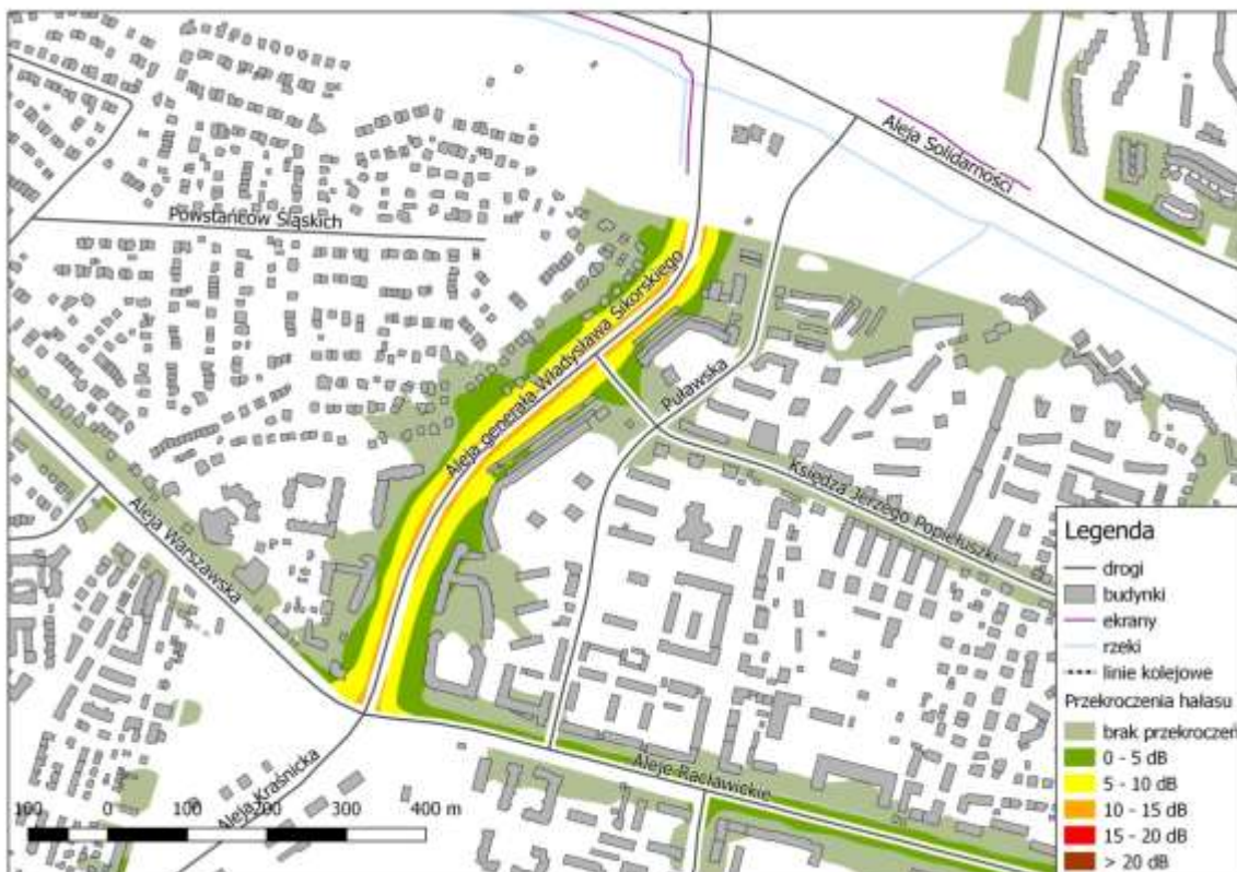
Rys. 3.3. Wycinek mapy przekroczeń poziomu hałasu pochodzącego od ruchu drogowego na terenie Miasta Lublin - wskaźnik L_N
