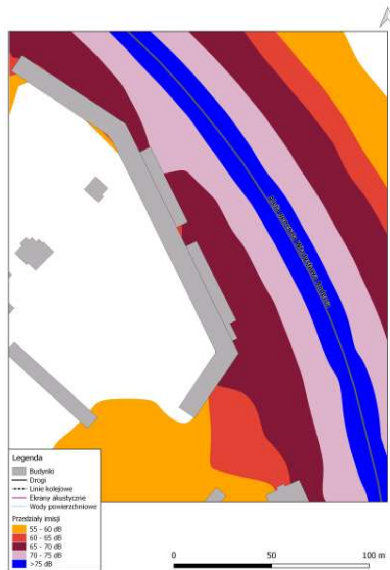
Rys. 8.54. Mapa imisji dźwięku – wskaźnik L_{DWN} , Al. Gen. Władysława Andersa na odcinku od ul. Lwowskiej do ul. Kalinowszczyzna, po zastosowaniu działań naprawczych
