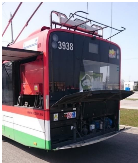
Zdjęcie 4 Układ jazdy autonomicznej zamontowany w zabudowie wieżowej trolejbusu Solaris Trollino 18
