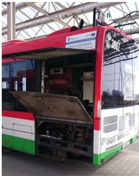
Zdjęcie 6 Układ jazdy autonomicznej zamontowany w zabudowie wieżowej trolejbusu Solaris Trollino 12
