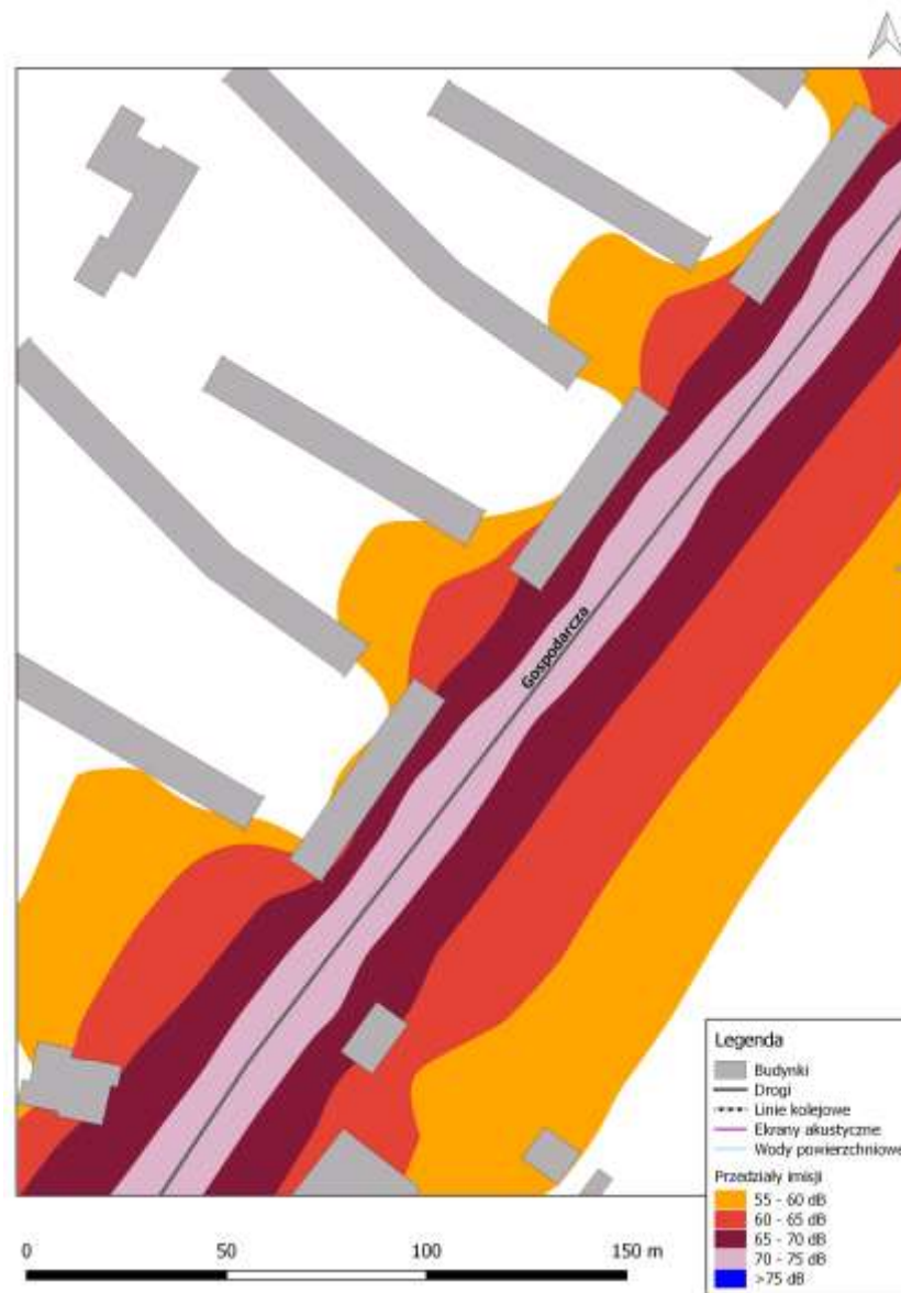
Rys. 8.18. Mapa imisji dźwięku – wskaźnik L_{DWN} , ul. Gospodarcza na odcinku od ul. Kresowej do ul. Hutniczej, po zastosowaniu działań naprawczych
