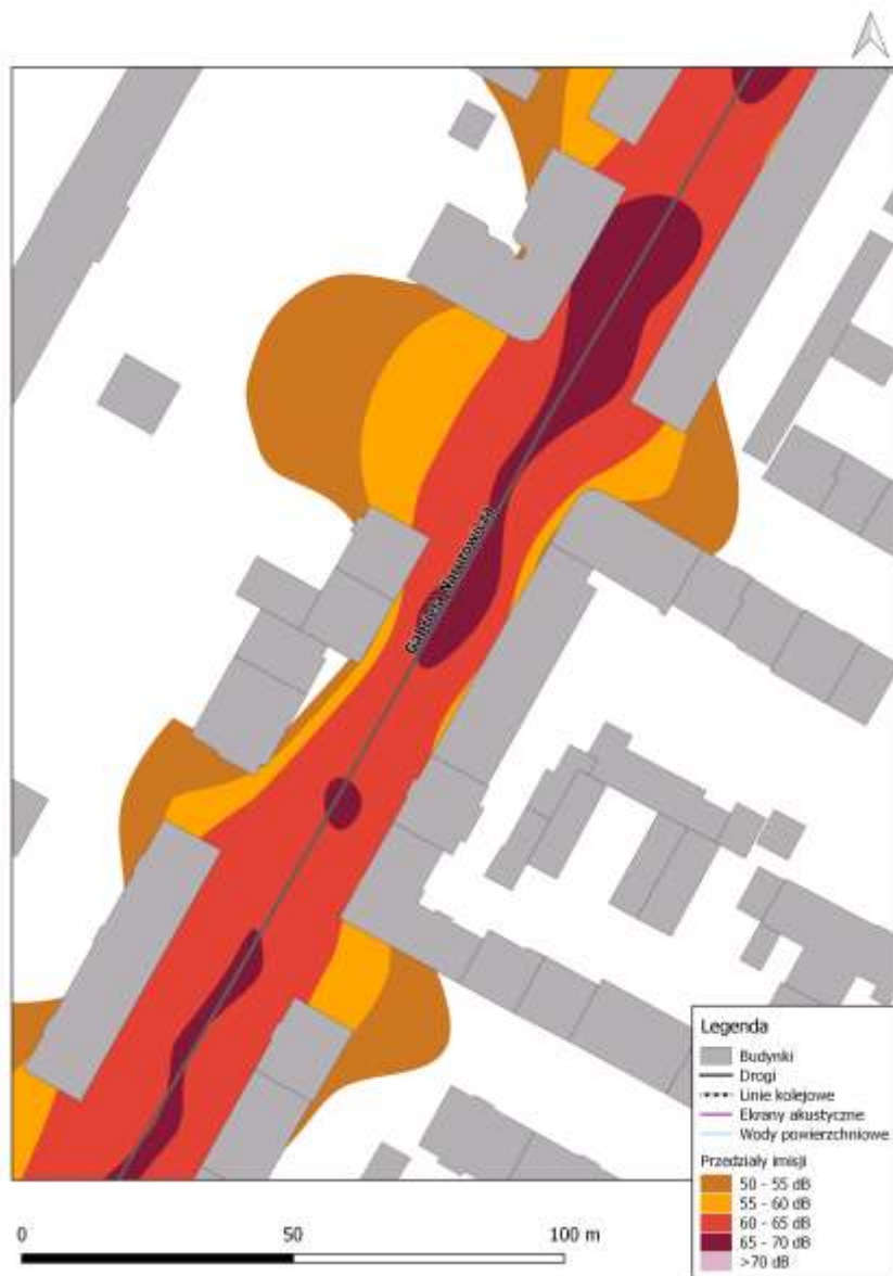
Rys. 8.31. Mapa emisji dźwięku – wskaźnik L_N , ul. Prezydenta Gabriela Narutowicza na odcinku od ul. Głębokiej do al. Józefa Piłsudskiego, przed zastosowaniem działań naprawczych
