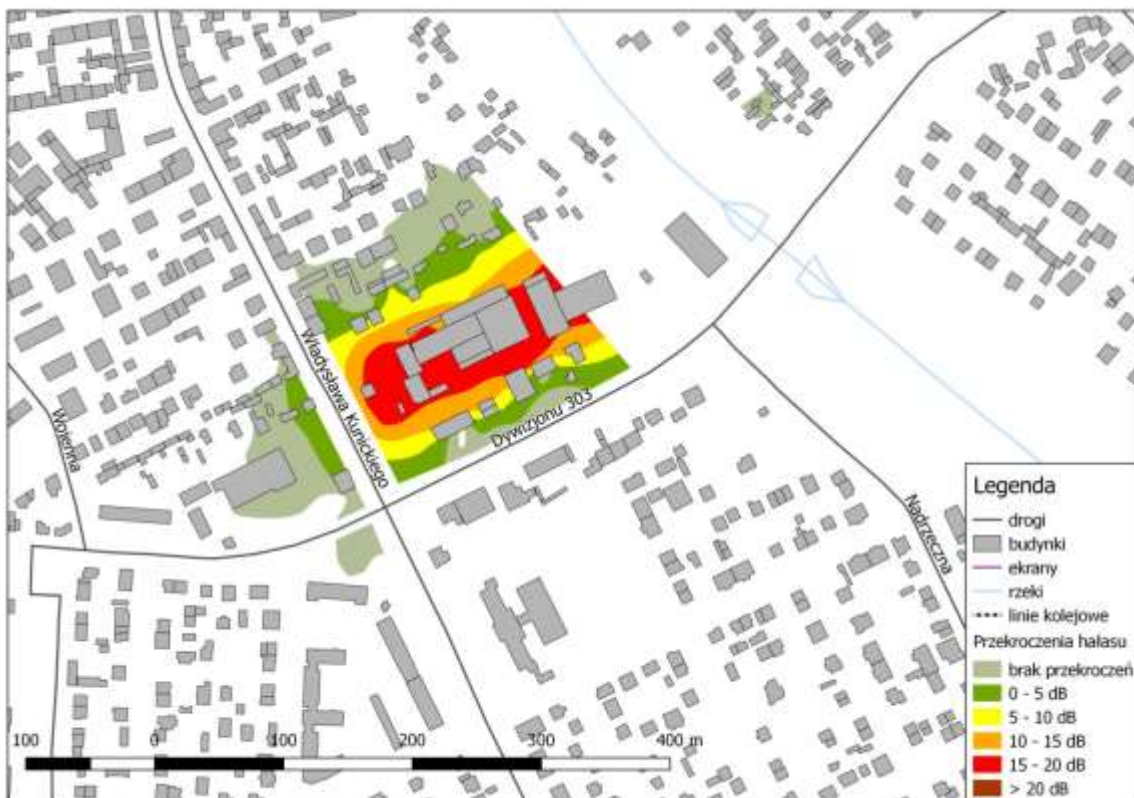
Rys. 3.5. Wycinek mapy przekroczeń poziomu hałasu przemysłowego na terenie Miasta Lublin - wskaźnik L_{DWN}
