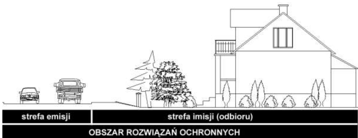
Rys. 5.6. Strefy emisji i imisji hałasu oraz obszar rozwiązań ochronnych w uniwersalnym podejściu do ochrony przed hałasem drogowym
