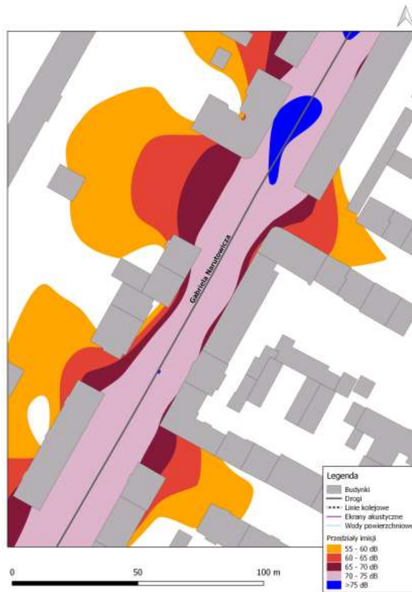
Rys. 8.30. Mapa imisji dźwięku – wskaźnik L_{DWN} , ul. Prezydenta Gabriela Narutowicza na odcinku od ul. Głębokiej do al. Józefa Piłsudskiego, po zastosowaniu działań naprawczych
