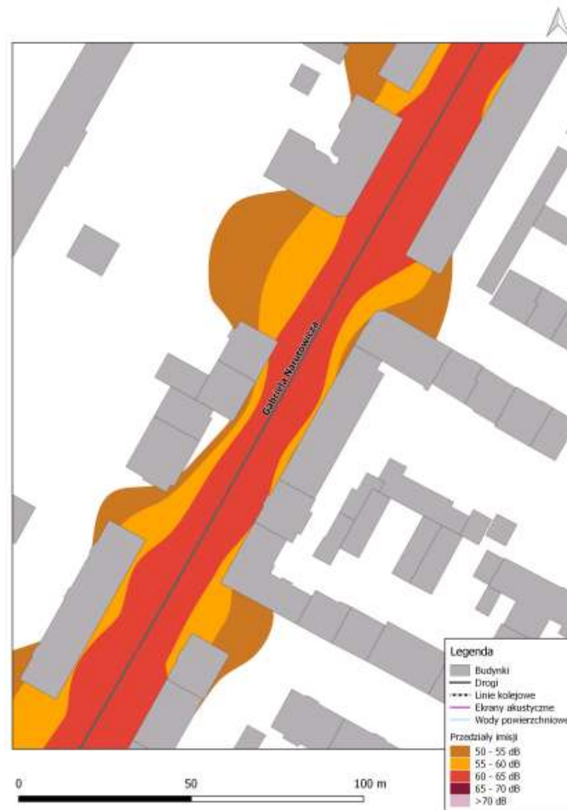
Rys. 8.32. Mapa emisji dźwięku – wskaźnik L_N , ul. Prezydenta Gabriela Narutowicza na odcinku od ul. Głębokiej do al. Józefa Piłsudskiego, po zastosowaniu działań naprawczych
