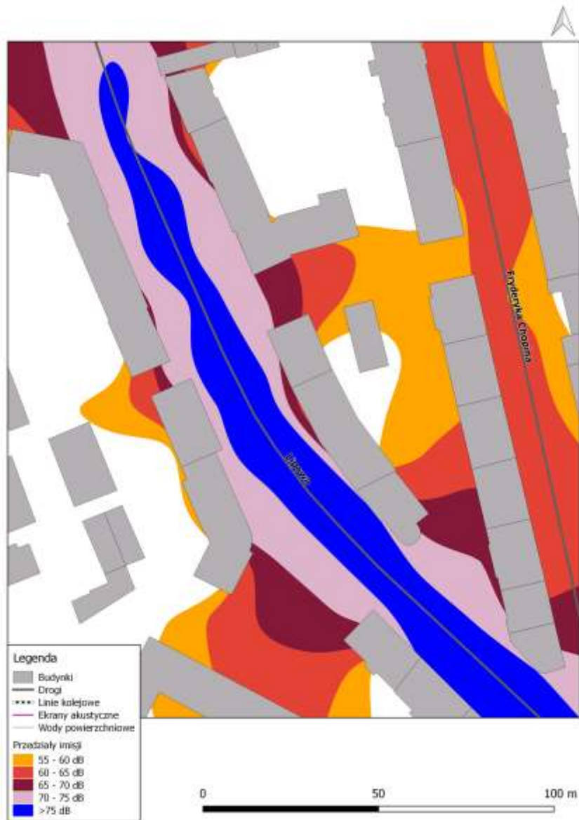
Rys. 8.41. Mapa emisji dźwięku – wskaźnik L_{pDWN} , Al. Józefa Piłsudskiego i ul. Lipowa na odcinku od ul. Dolnej Panny Marii do ul. Marii Curie-Skłodowskiej, przed zastosowaniem działań naprawczych
