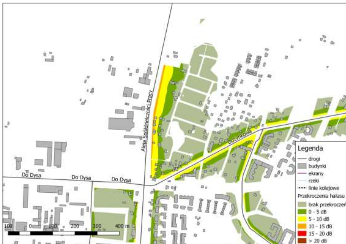
Rys. 3.2. Wycinek mapy przekroczeń poziomu hałasu pochodzącego od ruchu drogowego na terenie Miasta Lublin - wskaźnik L_{dwn}
