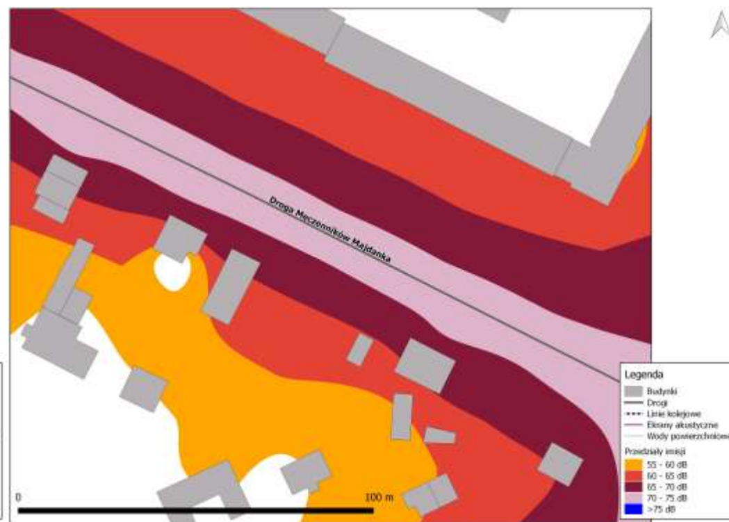
Rys. 8.6. Mapa imisji dźwięku – wskaźnik L_{p,wn} , ul. Droga Męczenników Majdanka na odcinku od ul. Lotniczej do ul. Krańcowej, po zastosowaniu działań naprawczych
