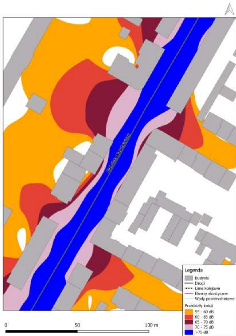
Rys. 8.29. Mapa imisji dźwięku – wskaźnik L_{DWN} , ul. Prezydenta Gabriela Narutowicza na odcinku od ul. Głębokiej do al. Józefa Piłsudskiego, przed zastosowaniem działań naprawczych
